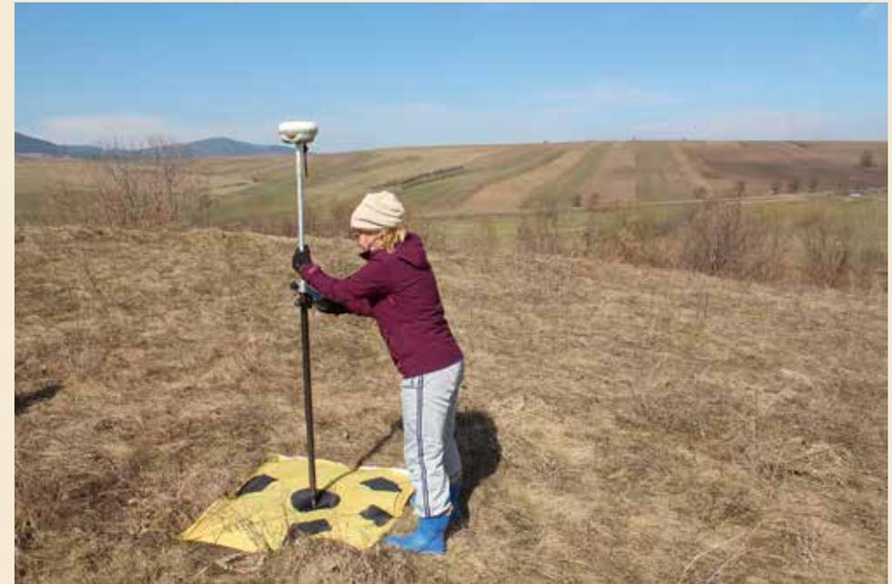
Unerlässlich für perfekte SfM-Modelle: Präzise Einmessung der Bodenkontrollpunkte (Foto: UFG-FAU).
