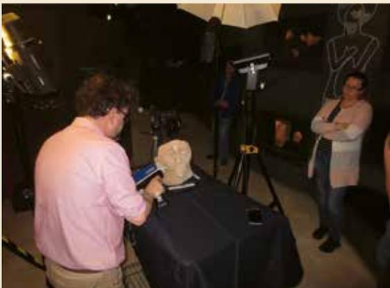
Röntgenfluoreszenzmessung mit dem XRF-Scanner am Kopf einer zweiten Statue (Foto: A. Posluschny).
