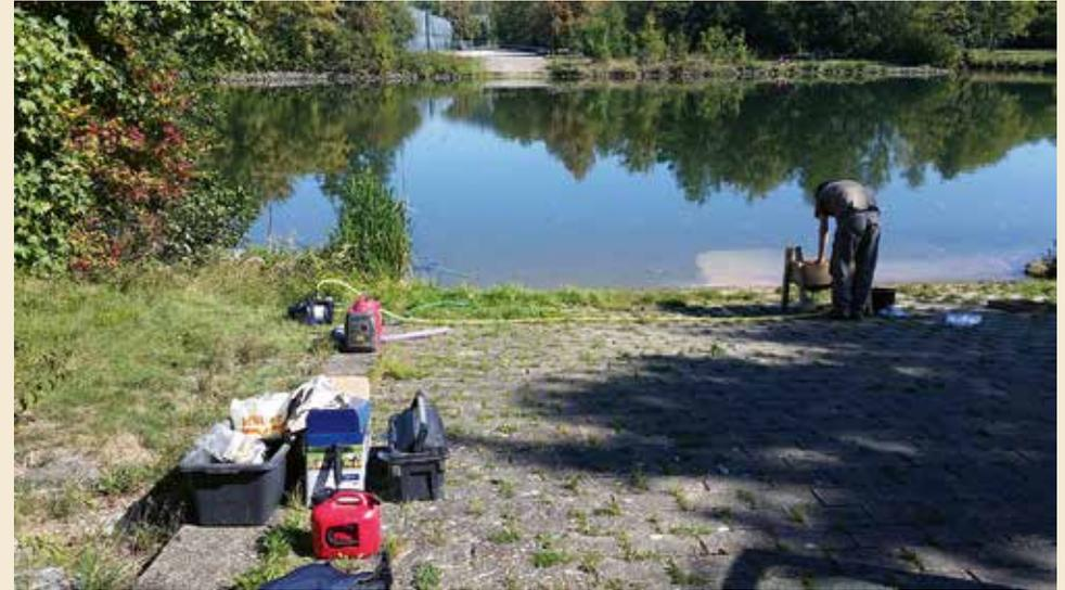
Schlämmanlage am Rhein-Main-Donaukanal zum Sieben der ausgegrabenen Sedimente mittels Wasserdruk.
